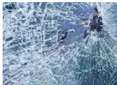
Bezpieczne szkło wielowarstwowe nie rozpada się mimo pęknięcia.
