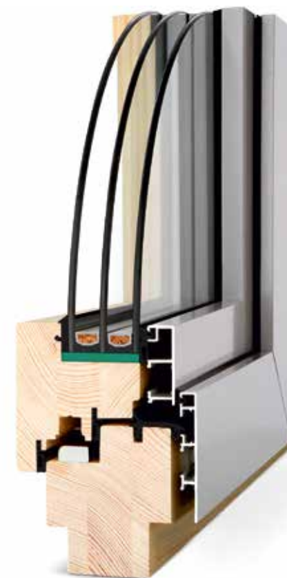
Przykład okna Comfort z okładziną aluminiową Quadrat i z zestawem lizszybowym: 4/14/4/14/4.
