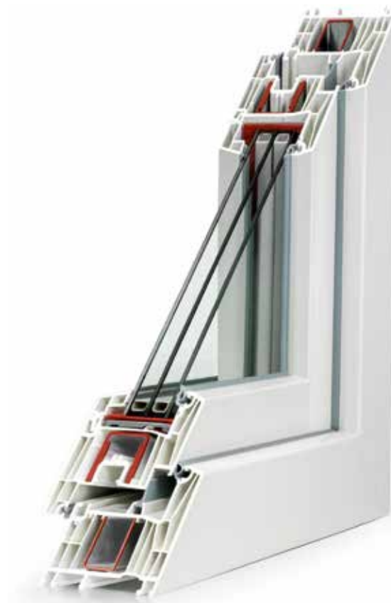
Przykład okna Warmic ze standardowym zestawem trzyszybowym: 4/16/4/14/4.
