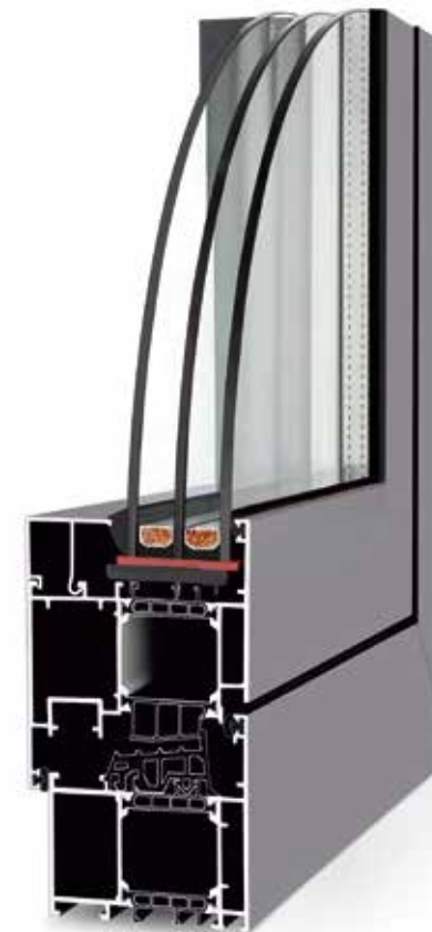
Przykład okna Forte ze standardowym zestawem trzyszybowym 4/18/4/18/4/18/4.
