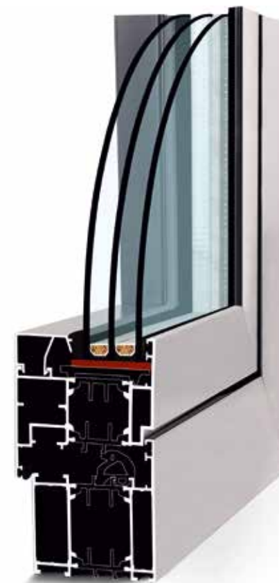
Przykład okna Medial z zestawem trzyszybowym 4/18/4/18/4.
