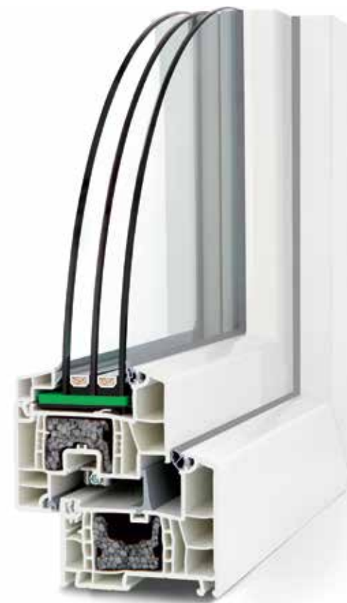
Przekład okna Hotic ze standardowym zestawem trzyszybowym: 4/18/4/18/4, wypełnienie termiczne - opcja.
