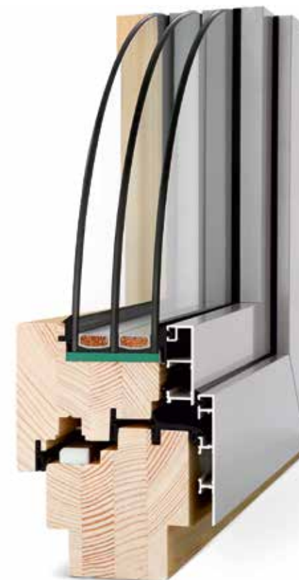
Przykład okna Record z okładziną aluminiową Quadrat i standardowym zestawem trzyszybowym: 4/14/4/14/4.
