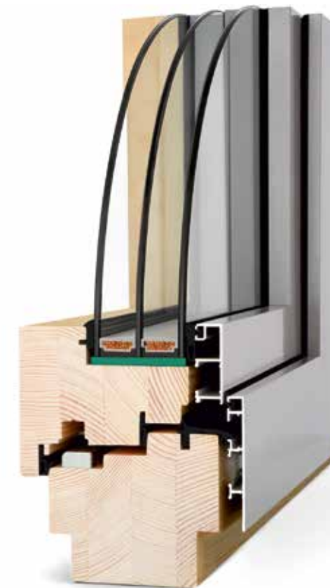
Przykład okna Prestige z okładziną aluminiową Quadrat i standardowym zestawem trzyszybowym: 4/16/4/16/4.
