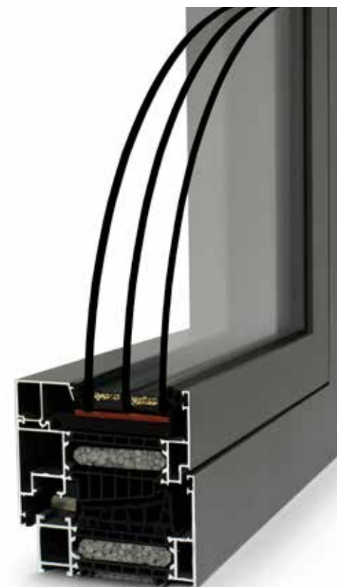
Przykład okna Grande Passive ze standardowym zestawem trzyszybowym 4/18/4/18/4.
