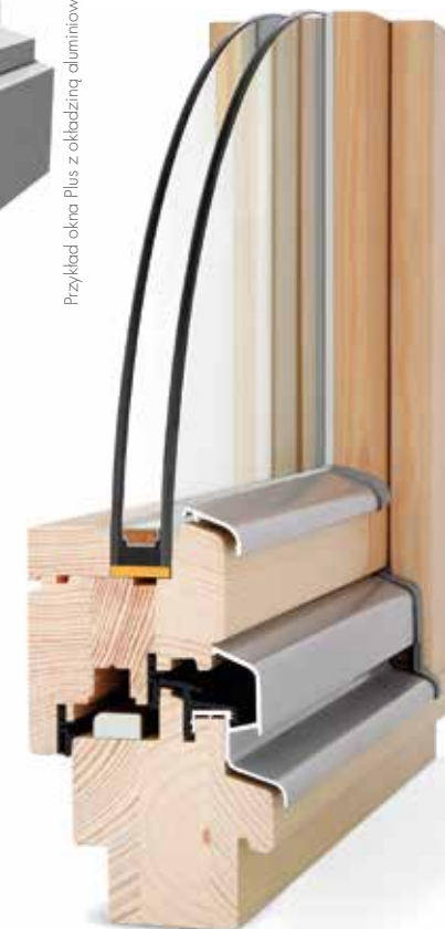
Przykład okna Plus z zestawem dwuszybowym: 4/16/4.
